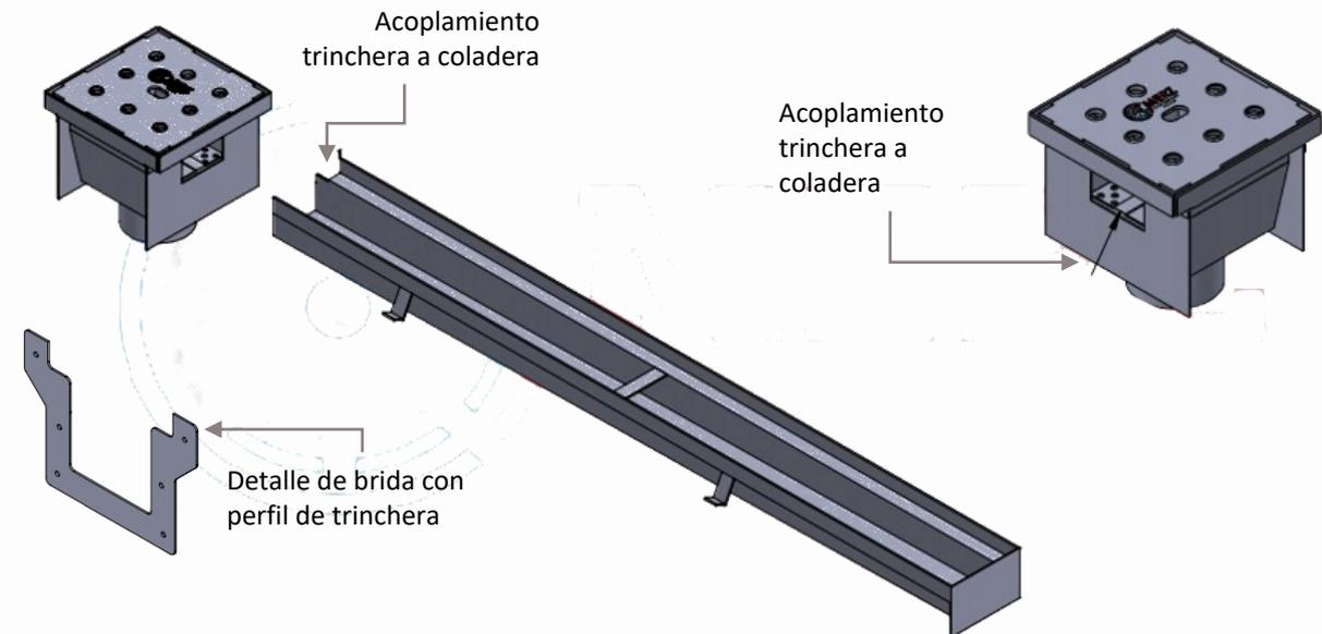
Detalles de acoplamiento de la canaleta a una coladera
