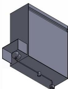
Esterilizador de cuchillos, ubicación del cable de conexión eléctrica.
