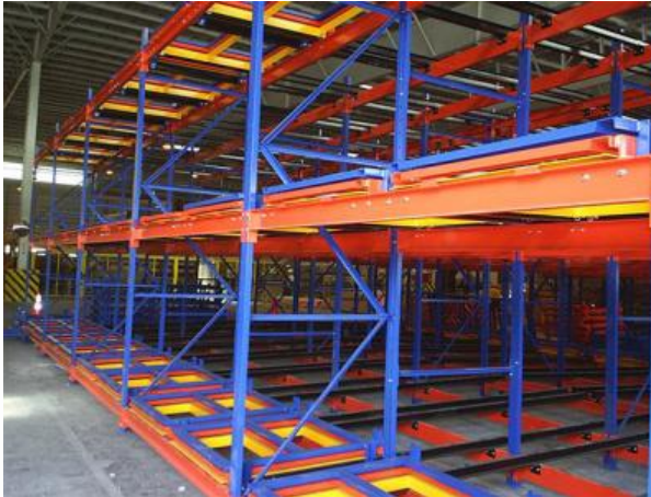
Vigas en naranja y marcos en azul (pintura horneada)
