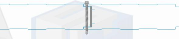
Fijación expuesta al centro de la unión entre paneles
