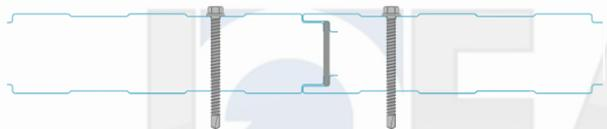
Fijación expuesta en ambos paneles
