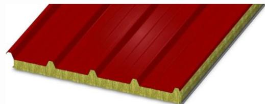
Lámina exterior perfilada en 5 crestas para aumentar la resistencia a cargas estáticas y dinámicas. Para pendientes no inferiores al 7%.
